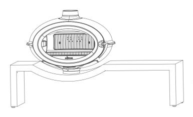
En fois le corps de chauffe entièrement solidaire sur son banc design, les sécurités et le système de levage peuvent être retirés.
