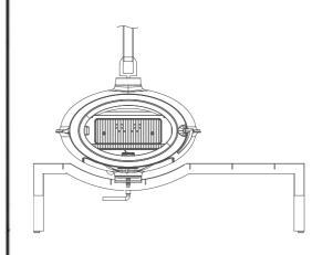
Terminer de serrer entièrement l'écrou M14 sur la tige filetée la tige filetée du corps de chauffe. Contrôler que le corps de chauffe est désormais entièrement solidaire de son banc design.
