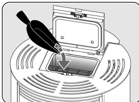
**!** ATTENTION: Le pellet qui chute par inadvertance hors du réservoir pendant les opérations de remplissage peut entrer en contact avec des composants très chauds de l'appareil avec le risque d'incendie. Il est donc nécessaire d'utiliser une pelle spéciale, afin de pas appuyer le poids du sac de granulés sur l'appareil et / ou de ne pas mettre le sac en contact avec les surfaces chaudes du même.
